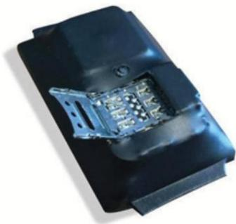
2. Legen Sie eine SIM-Karte mit ausgeschaltetem PIN-Code oder eine Speicherkarte ein in das Gerät.
